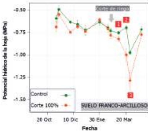
Figura 19: Potencial hídrico de la hoja en un huerto con suelo franco-arcilloso. Línea verde refleja en riego control del productor, y línea naranja la aplicación de RDC.
