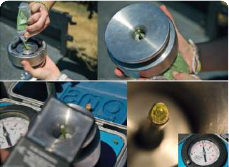
Figura 15: Medición de potencial hídrico en hoja mediante el uso de la bomba tipo Scholander.
