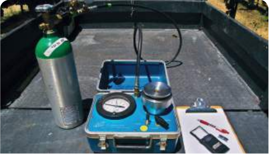
Figura 14: Cámara tipo Scholander para el cálculo de potencial hídrico
